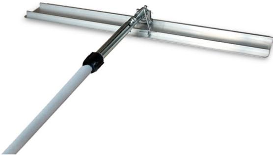
Fratacho fabricado en aleación de aluminio para una vida útil prolongada. Las esquinas de la hoja están redondeadas para no dejar marcas. La inclinación de la hoja es ajustable y controlada mediante la rotación del mango. Esto permite variar la inclinación de la hoja para lograr el acabado óptimo para el hormigón. Si la hoja queda plana sobre la losa deja un acabado rugoso.
