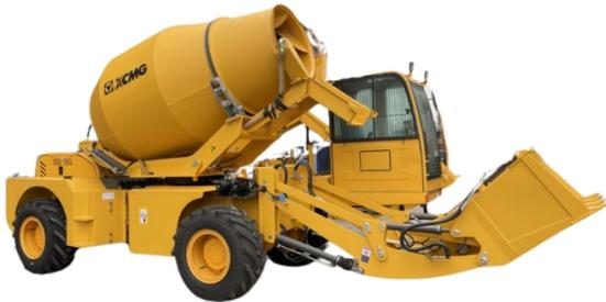
La autohormigonera es la combinación de un camión hormigonera y una hormigonera, que puede alimentar, medir, mezclar y descargar automáticamente la mezcla de hormigón. Equipada con un potente motor y dirección en las 4 ruedas, la hormigonera autocargable es como un coche pequeño y el operador puede llevarla a donde necesite ir.
